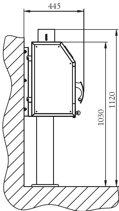
Рисунок 2. Габаритные размеры печи установленной на опору.
