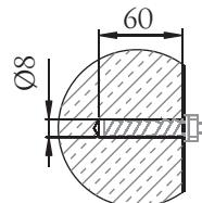
Рисунок 7. Отверстие в стене под анкерный болт.
