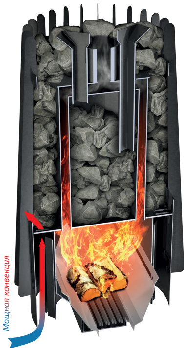
Рис. 3 Устройство и работа печи
